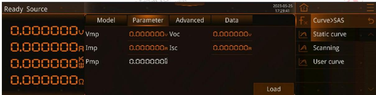
Figure 150-SAS-Static Curve-Curve Parameter Screen
